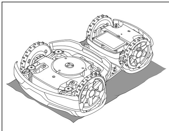
3. Reinigen Sie den Messerteller mit einer Bürste.
