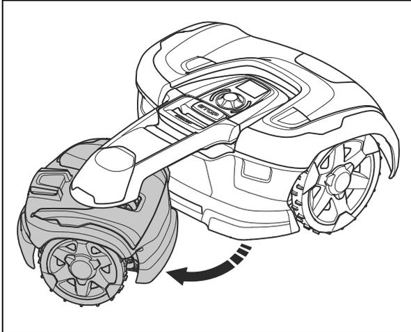
3. Bringen Sie zwischen der Abdeckung und dem Verbindungsarm einen Schutz an, um Beschädigungen an der oberen Abdeckung zu vermeiden.
