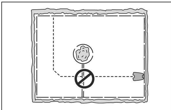
Um eine Insel zu erstellen, isolieren Sie Bereiche im Arbeitsbereich mit dem Begrenzungskabel. Wir empfehlen, alle festen Objekte im Arbeitsbereich zu isolieren.
