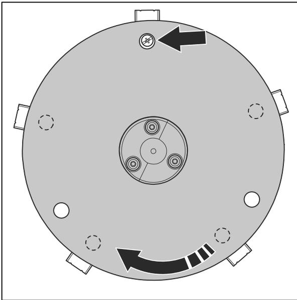
5. Entfernen Sie die 5 Schrauben.
