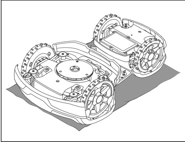
4. Drehen Sie die Gleitplatte, bis die Löcher über den Schrauben für die Klingen stehen.
