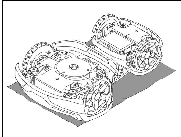
3. Entfernen Sie die 6 Schrauben und nehmen Sie die Akku-Abdeckung ab.
