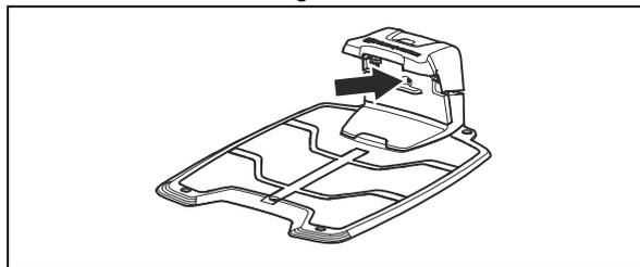
2. Wenn die LED-Anzeigeleuchte nicht grün leuchtet, führen Sie eine Überprüfung der Installation durch. Siehe *LED Anzeigelampe der Ladestation auf Seite 42* und *Installieren der Ladestation auf Seite 16*.
