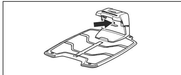
2. Prüfen Sie, ob Begrenzungskabelanschlüsse an der Ladestation korrekt vorgenommen wurden und nicht beschädigt sind. Prüfen Sie, ob die Anzeigelampe an der Ladestation noch immer blau blinkt.
