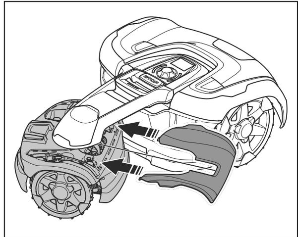
2. Bringen Sie die Abdeckung in Position (A) und drücken Sie auf die beiden Magnete, um die obere Abdeckung (B) anzubringen.
