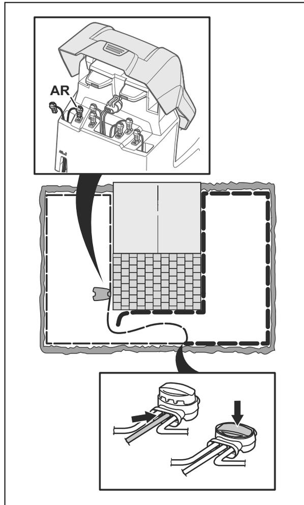
Leuchtet die Anzeigelampe jetzt grün, befindet sich der Bruch an einer Stelle zwischen dem ausgesteckten Ende und der Stelle, an der das neue Kabel angeschlossen wurde (dicke schwarze Linie unten). Verschieben Sie in diesem Fall das neue Kabel näher in Richtung ausgestecktes Ende (ungefähr in der Mitte des Bereichs, in dem der Bruch vermutet wird), und prüfen Sie erneut, ob die Anzeigelampe grün leuchtet.
