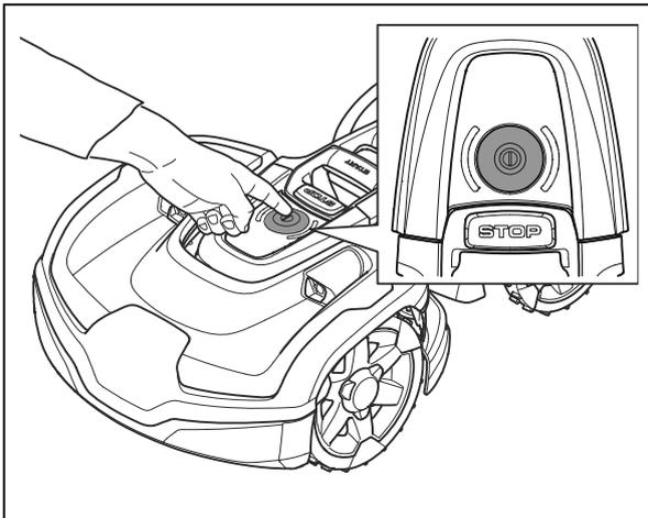
2. Drücken Sie die **ON/OFF**-Taste 3 Sekunden lang. Stellen Sie sicher, dass die LED-Anzeigelampe erlischt.
