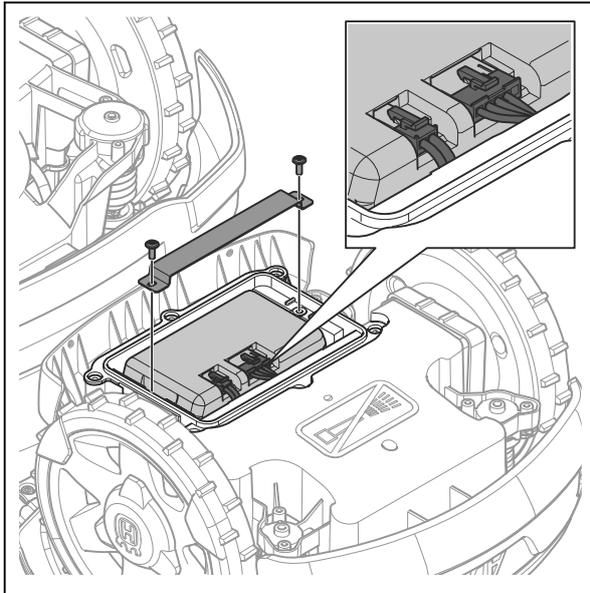
5. Entfernen Sie die 2 Kabel vom Akku und nehmen Sie den Akku heraus.
