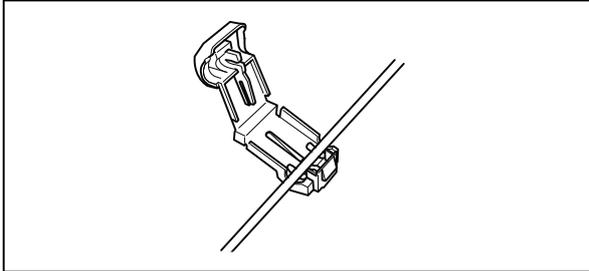
3. Schließen Sie die Anschlussklemme mit einer Zange.
