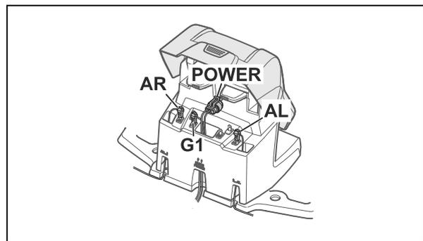
3. Verbinden Sie die Anschlüsse von Leitkabel und Begrenzungskabel mit der Ladestation.
