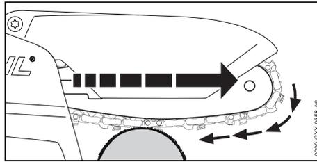
Wenn mit der Unterseite der Führungsschiene gearbeitet wird, wird der Gehölzschnneider weg vom Benutzer gezogen.
