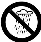
Ne pas travailler avec la machine sous la pluie, à un endroit mouillé ou dans une ambiance très humide – le moteur électrique n'est pas protégé contre la pénétration de l'eau.
