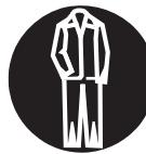
Die Kleidung muss zweckmäßig sein und darf nicht behindern. Eng anliegende Kleidung mit **Schnittschutzeinlage** – kein Arbeitsmantel.
