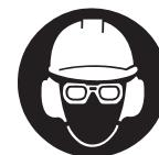
Per ridurre il pericolo di lesioni agli occhi, portare occhiali di protezione ben aderenti secondo la norma EN 166 o una visiera. Badare alla corretta posizione degli occhiali di protezione e della visiera.
