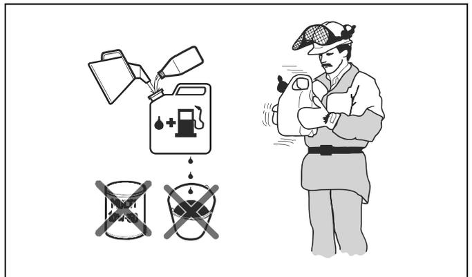
1. Füllen die Hälfte des Benzins in einen sauberen Kraftstoffbehälter.
