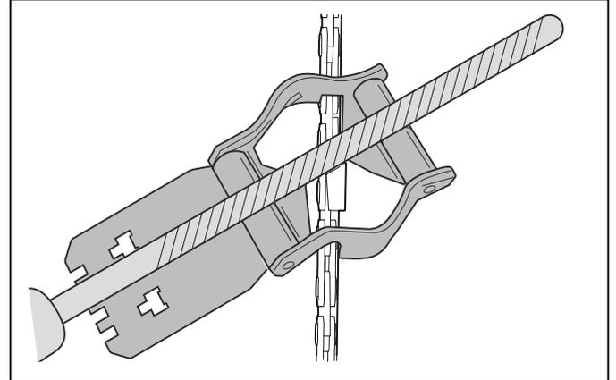
4. Entfernen Sie Material von der einen Seite aller Schneidezähne.
