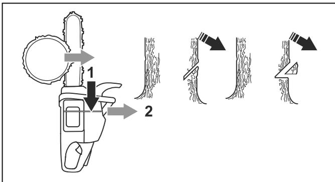
2. Stellen Sie sicher, dass der untere Kerbschnitt horizontal ausgerichtet ist und im Winkel von  $90^\circ$  zur Fällrichtung ist.
