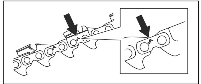
2. Sorgen Sie dafür, dass die Sägekette einfach zu biegen ist. Tauschen Sie die Sägekette aus, wenn sie zu starr ist.
