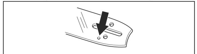
2. Prüfen Sie, ob sich an den Kanten der Führungsschiene Grate gebildet haben. Entfernen Sie Grate mit einer Feile.
