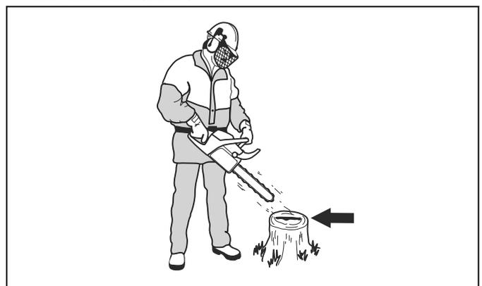
3. Wenn die Sägekettenschmierung nicht ordnungsgemäß funktioniert, führen Sie eine Prüfung der Führungsschiene durch. Eine Anleitung finden Sie in *So prüfen Sie die Führungsschiene auf Seite 33*. Wenden Sie sich an den Kundendienst, wenn Sie mit den Wartungsschritten das Problem nicht beheben können.
