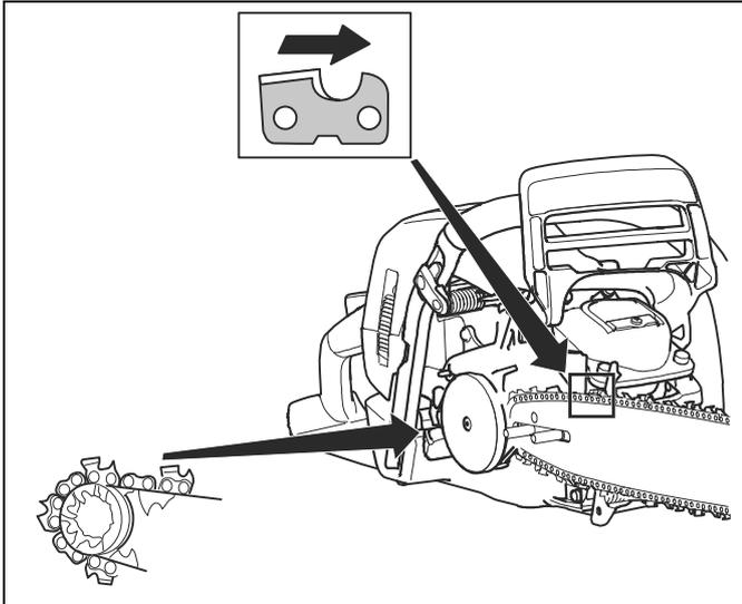
6. Richten Sie das Loch in der Führungsschiene an dem Stift der Ketteneinstellung aus, und befestigen Sie den Kupplungsdeckel.
