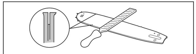
3. Reinigen Sie die Nut in der Führungsschiene.
