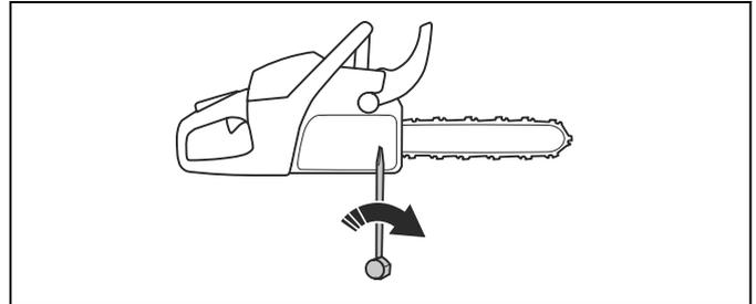
5. Ziehen Sie die Mutter der Führungsschiene mit dem Zoll-Schraubenschlüssel an, und heben Sie gleichzeitig die Vorderseite der Führungsschiene an.
