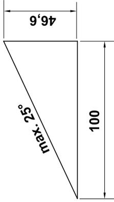
Um eine ausreichende Schmierung des Verbrennungsmotors sicherzustellen, sind beim Einsatz des Geräts an Hängen ergänzend die Angaben in der mitgelieferten Gebrauchsanleitung Verbrennungsmotor zu beachten.
