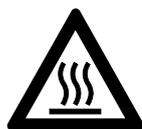
Hete machineonderdelen en de aandrijfkop niet aanraken – **kans op brandwonden!**
