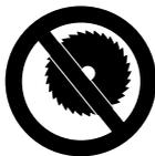
De beschermkap mag niet in combinatie met cirkelzaagbladen worden gebruikt.
