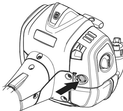
**Choke:** Den Chokehebel in Choke-Lage führen.
