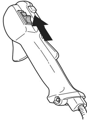
**ACHTUNG!** Der Stoppschalter geht automatisch in die Startstellung zurück. Um ein ungewolltes Starten zu vermeiden, muss bei Montage, Kontrolle und/oder Wartung daher stets die Zündkappe von der Zündkerze entfernt werden.
