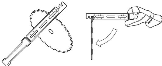
Die Schneidausrüstung auf Beschädigung und Risse kontrollieren. Beschädigte Schneidausrüstungen sind grundsätzlich auszutauschen.
