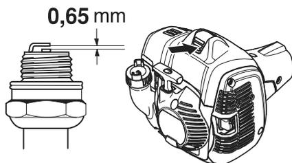
**ACHTUNG!** Stets den vom Hersteller empfohlenen Zündkerzentyp verwenden! Eine ungeeignete Zündkerze kann Kolben und Zylinder zerstören. Dafür sorgen, dass die Zündkerze eine sog. Funkentstörung hat.
