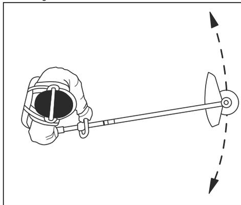
Stellen Sie sicher, dass der Rasentrimmerfaden beim Schneiden parallel zum Boden läuft.
