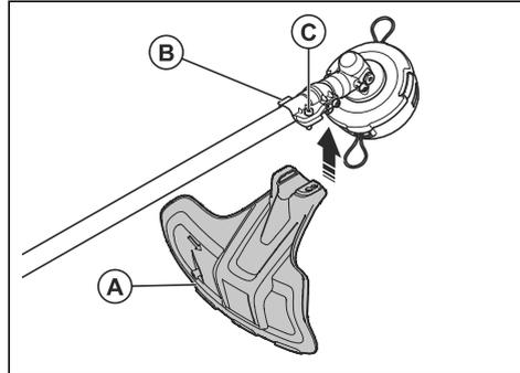
2. Bringen Sie den Schutz für die Schneidausrüstung an der Welle an und ziehen Sie ihn mit der Schraube (C) fest.
