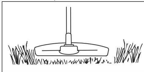
2. Drücken Sie den Trimmerkopf nicht auf den Boden. Der Boden und das Gerät könnten dadurch beschädigt werden.
