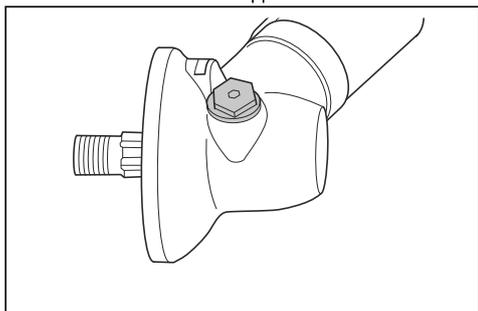
4. Sehen Sie in die Schmiernippel-offnung hinein, und drehen Sie die Antriebswelle. Der Schmierfettstand (A) muss sich auf Hohe der Zahnoberseite (B) befinden.
