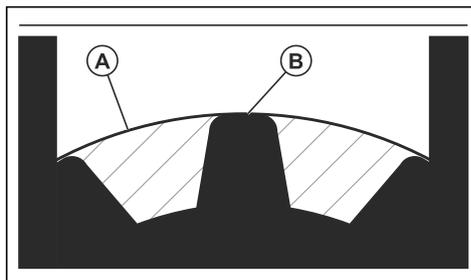
5. Wenn der Schmierfettstand zu niedrig ist, fullen Sie das Winkelgetriebe mit Husqvarna Schmierfett fur Winkelgetriebe. Fullen Sie es langsam ein, und drehen Sie die Antriebswelle dabei. Stoppen Sie beim korrekten Fullstand (B).
