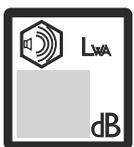
Etikett mit Geräuschemissionen gemäß EU- und UK-Verordnungen und Richtlinien (plus Verordnungen aus New South Wales). Der garantierte Schalleistungspegel des Geräts ist unter *Technische Angaben auf Seite 17* und auf dem Etikett angegeben.
