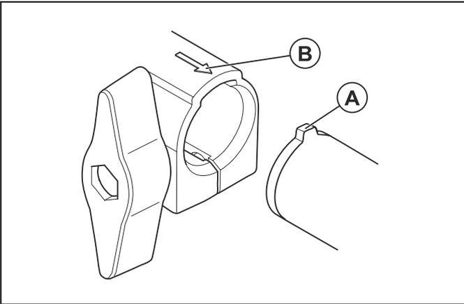
3. Drücken Sie das Führungsrohr in die Kupplung bis zum Einrasten in seine Position.
