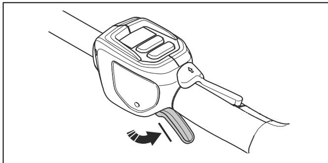
2. Drücken Sie die Gashebelsperre nach vorn (A) und nach unten. Drücken Sie die Gashebelsperre gegen den Griff (B), und stellen Sie sicher, dass sie in ihre ursprüngliche Position zurückspringt, wenn Sie sie loslassen.
