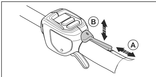
3. Stellen Sie sicher, dass sich der Gashebel und die Gashebelsperre frei bewegen können und dass die Rückstellfeder richtig funktioniert.
