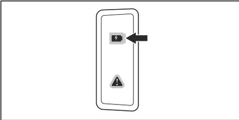
4. Wenn alle LEDs am Akku leuchten, ist er vollständig aufgeladen.
