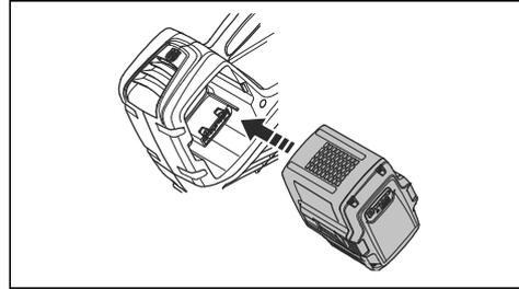
3. Drücken Sie den unteren Teil des Akkus so weit wie möglich in das Akkufach. Der Akku verriegelt sich mit einem hörbaren Klickgeräusch in der richtigen Position.
