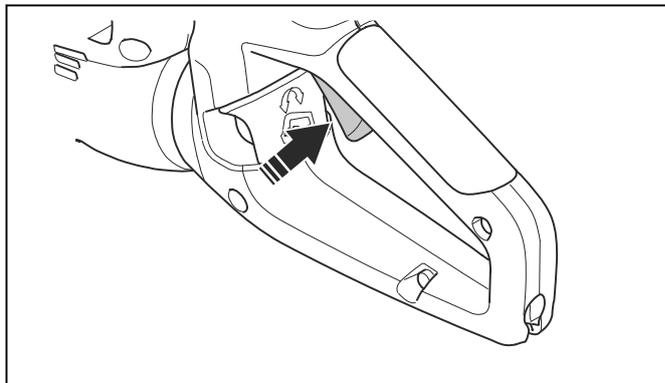
4. Relâchez la gâchette de puissance et assurez-vous que le ressort de rappel fonctionne correctement. La lame doit s'arrêter en moins d'une seconde.
