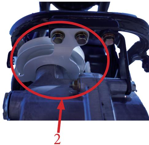
Nun können Sie den Keilriemen entnehmen. Der Einbau erfolgt in umgekehrter Reihenfolge.
