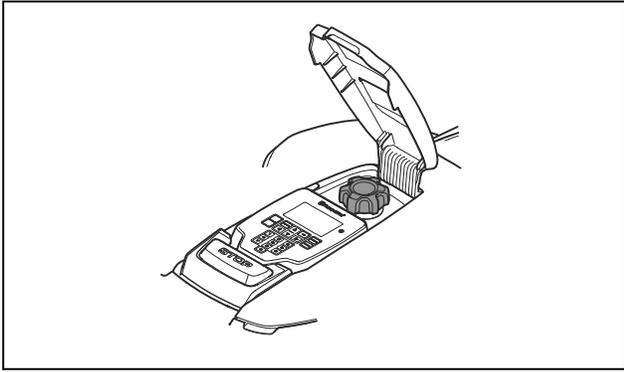
3. Ruotare la manopola di regolazione dell'altezza di taglio per selezionare un'altezza di taglio.
