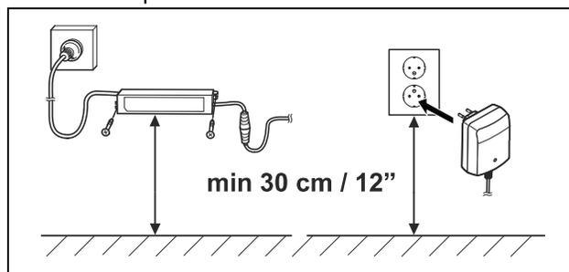
5. Collegare il cavo di alimentazione a una presa da 100-240 V.
