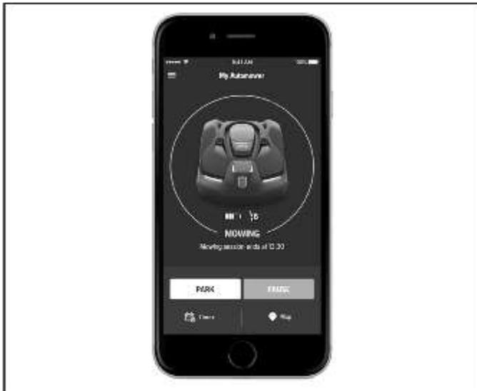
Die Automower® Connect-App verbindet sich bei großen Entfernungen über Mobilfunk, über Wi-Fi und bei kleinen Entfernungen über Bluetooth®.
