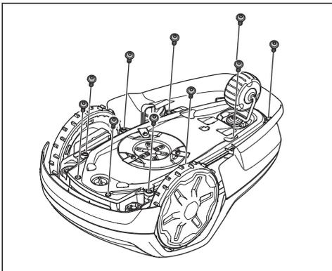
5. Soulevez avec précaution la partie inférieure du châssis et placez-la à côté du châssis supérieur.
