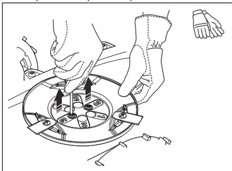
8. Sélectionnez une hauteur de coupe et alignez les 2 trous du disque de coupe avec les 2 trous de l'arbre.
