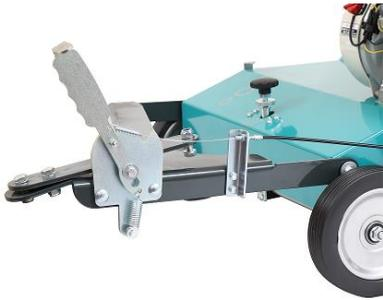
Den Motor gemäß der Betriebsanleitung des Vertikutierers einschalten. Mit dem Kupplungshebel kann die Messerwelle eingekuppelt oder ausgekuppelt werden. Zum Verstellen des Kupplungshebels, diesen anziehen und damit aus der Verankerung lösen, anschließend in der gewünschten Position verstellen und einrasten lassen.
