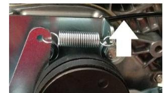
11. Den montierten Bowdenzug nicht lose hängen lassen, sondern hinter der Keilriemenschutz-Abdeckung zum Kupplungshebel führen. Die Riemenschutz-Abdeckung wieder befestigen.
