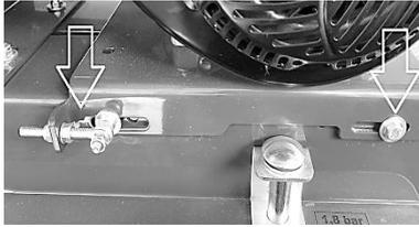
Der Keilriemen lässt sich über die Sechskantmuttern auf beiden Seiten der Maschine spannen.
