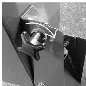
3. Mit der Sternschraube den Astrichter an der Halterung von Punkt 2 befestigen.
