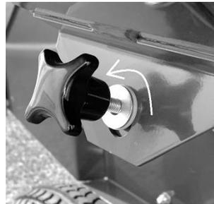
1. Um den Astrichter öffnen zu können, muss die Sternschraube unter Punkt 1 gelöst werden.
