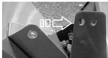
2. Anschließend den Astrichter zum Fülltrichter schwenken bis die Bohrungen mit der Halterung (2) aufeinander liegen.
