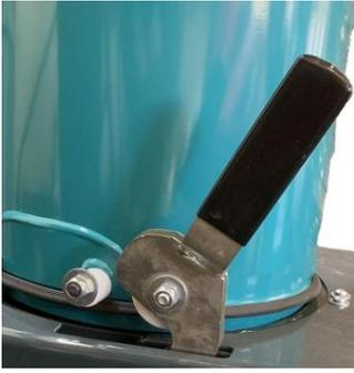
Der Fülltrichter lässt sich durch den seitlichen Verschlusshebel leicht öffnen. Den Hebel nach rechts von der Verriegelung lösen.
