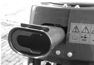
Der Aststutzen mit seiner ovalen Form nimmt dickeres Material als der Fülltrichter auf. Die eingesetzte Verengung verhindert unbeabsichtigtes Hineingreifen. Um den Aststutzen nicht zu beschädigen, zu lange und krumme Äste vorab kürzen.
