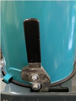
Zum Schließen des Fülltrichters den Trichterkopf wieder auf die Öffnung zurückklappen.
