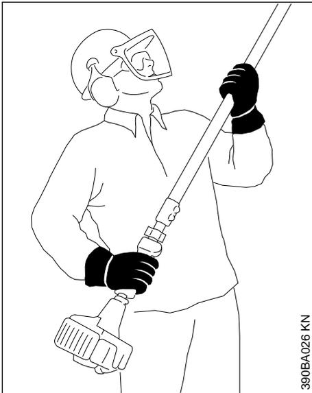
Pour pouvoir manier la machine en toute sécurité, toujours la tenir fermement **à deux mains** – la poignée de commande de la main droite, le tube de la main gauche – ceci est également valable pour les gauchers. Entourer fermement la poignée de commande et le tube avec les pouces.
