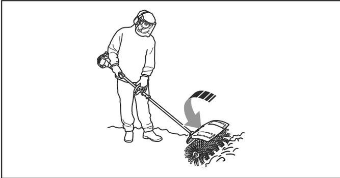
3. Afin d'accéder dans les coins, déposez le pare-boue, desserrez le raccord de l'accessoire et faites pivoter l'accessoire d'un demi-tour.
