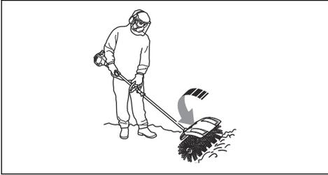
3. Um in Ecken zu gelangen, entfernen Sie den Spritzschutz, lösen Sie die Zubehörcupplung und drehen das Zubehör um eine halbe Drehung.
