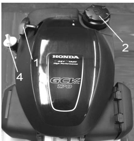
Die Kehrmaschine ist mit einem luftgekühlten Honda 1-Zylinder 4-Takt-Benzinmotor ausgestattet. Detailliertere Erklärungen können Sie aus der beiliegenden Motorbedienungsanleitung entnehmen.
