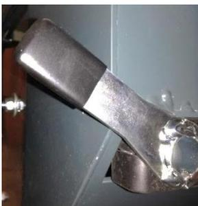
Durch verstellen des Hebels kann von Getriebeantrieb (M) auf Fortbewegung per Hand umgestellt werden. Für die Fortbewegung per Hand den Hebel zur rechten Seite schieben.
