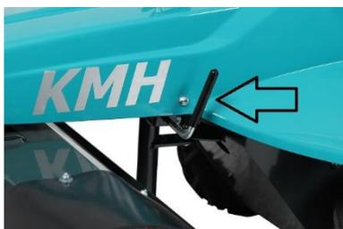
Das Stützrad kann durch die Verstellung des Hebels festgesetzt werden. Mit einem festgesetzten Stützrad ist das Arbeiten mit einer schräg stehenden Bürste leichter. Hierbei ist die Fahrtrichtung der Kkehrmaschine trotz der schrägstehenden Bürsten geradeaus.
