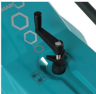
Mit der Kurbel wird über die Stützrad-einstellung die Höhe der Kkehrbürsten verändert. Die Borsten der Kkehrbürsten sollten für die optimale Einstellung gerade so den Boden berühren. Eine zu tiefe Einstellung der Kkehrbürste führt zu einer Überbelastung der Antriebe und zu einem unnötigen Verschleiß der Bürsten.
