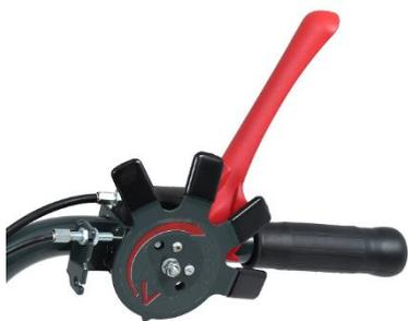
**Easy Drive aktiv:** Die Fahrgeschwindigkeit vorwärts kann mit der Drehung des Einstellrades stufenlos variiert werden. Rückwärtsfahren ist mit dem Easy Drive nicht möglich. Für die Rückwärtsbewegung den Easy Drive auf 0 stellen, die Bürsten vorne leicht anheben und die Maschine nach hinten ziehen.
