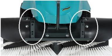
An den abgebildeten Aufnahmepunkten können Remarc-Frontgeräte (wie Schneeräumschild, Kehrgutbehälter usw.) montiert werden. Eine vollständige Liste des Remarc-Zubehörs finden Sie in unserem Katalog oder auf unserer Internetseite.
