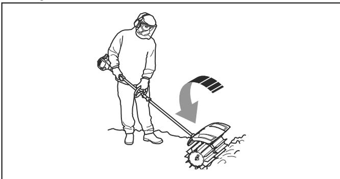
3. Um in Ecken zu gelangen, entfernen Sie den Spritzschutz, lösen die Zubehörcupplung und drehen das Zubehör um eine halbe Drehung.
