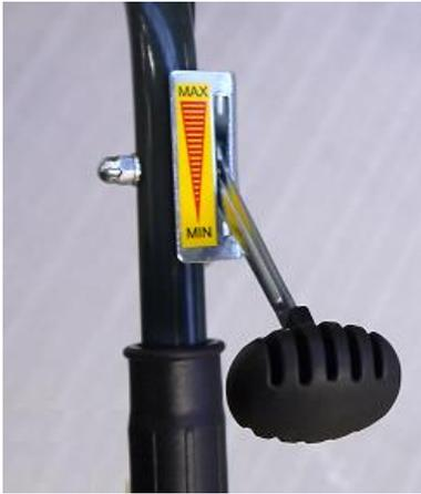
Um die Maschine starten zu können, muss der Gas-Hebel für die Motorleistung richtig eingestellt werden. Folgende Einstellungen sind möglich:
