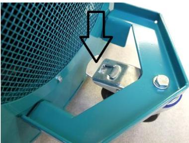
Die Aktivierung der Feststellbremse verhindert das ungewollte Wegrollen der Maschine.
