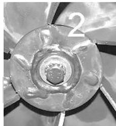
Anschließend die M8-Sechskantschraube (2) aus dem Gebläserotor herausdrehen.
