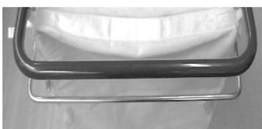
Mit dem Steuerbügel wird die Maschine gelenkt. Während der Arbeit sollten aus Sicherheitsgründen beide Hände an dem Steuerbügel sein.
