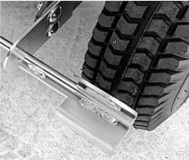
Die Maschine kann mit einer Feststellbremse vor dem Wegrollen gesichert werden.
