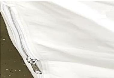
Entleeren durch öffnen des Reißverschlusses an der Rückseite des Fangsackes.
