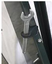
Der abgebildete Schraubenschlüssel ist an einer Halterung am Lenkbügel befestigt.
