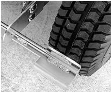
Die Maschine kann mit einer Feststellbremse vor dem Wegrollen gesichert werden.
