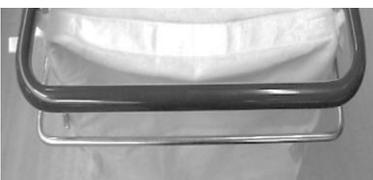
Mit dem Steuerbügel wird die Maschine gelenkt. Während der Arbeit sollten aus Sicherheitsgründen beide Hände an dem Steuerbügel sein. Bei dem Modell ohne Antrieb darf die Maschine nur an dem Steuerbügel geschoben oder gezogen werden.
