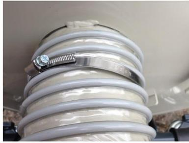
Hierfür die Schlauchschelle auf das Schlauchende schieben. Nun den Schlauch ganz auf den Saugstutzen schieben und die Schlauchschelle an der Schraube festziehen. (Siehe Bild)
