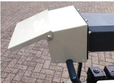
Die Klappe vom Auswurfschacht lässt sich öffnen. Mit der Klappe lässt sie etwas der Auswurf lenken.
