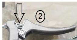
Handbremse festsetzen (2): Den angezogenen Bremshebel halten und die Verriegelung (PFEIL, Verriegelungs-Hebel befindet sich unterhalb der Handbremse) in die Handbremse einsetzen. Zum Lösen der Handbremse, diese leicht anziehen und die Verriegelung durch Drücken des Verriegelungs-Hebels entfernen.
