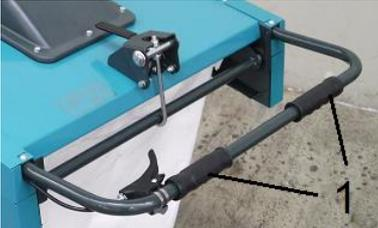
Mit dem Steuerbügel wird die Maschine gelenkt. Während der Arbeit sollten aus Sicherheitsgründen beide Hände an dem Steuerbügel sein. Bei dem Modell ohne Antrieb (LS 5.0) sollte die Maschine nur an dem Steuerbügel geschoben oder gezogen werden.
