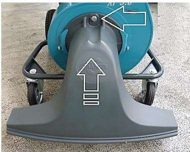
Zum Entfernen des Saugrüssels für Reparatur- und Wartungsarbeiten den beiliegenden Schraubenschlüssel verwenden.
