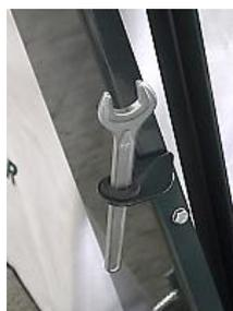
Der abgebildete Schraubenschlüssel ist an einer Halterung am Lenkholm befestigt.
