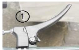
Damit die Maschine nicht Wegrollen kann oder für die Arbeit an Hängen ist eine Handbremse auf der linken Seite vom Steuerbügel angebracht.
