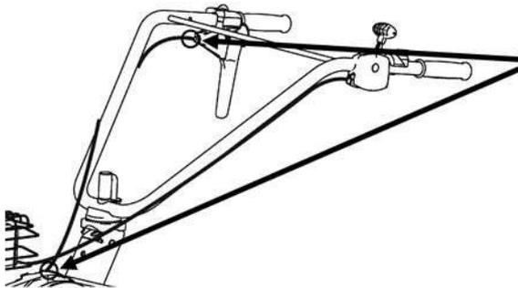
1- Lubrifier le câble d'embrayage à l'aide d'un lubrifiant pour câble au PTFE
