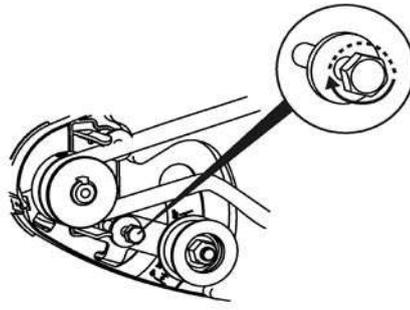
3- Desserrer la vis de fixation de l'axe du levier d'embrayage (2 tours)
