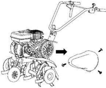
1- Enlever les 3 vis de fixation du capot courroie
