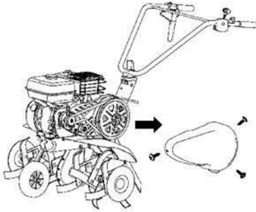
1- Die 3 Befestigungsschrauben von der Keilriemenhaube abnehmen
