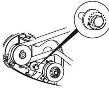
3- Die Befestigungsschraube der Achse des Kupplungshebels lockern (2 Umdrehungen)
