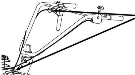
1- Das Kupplungskabel mithilfe eines Schmiermittels für PTFE-Kabel schmieren
