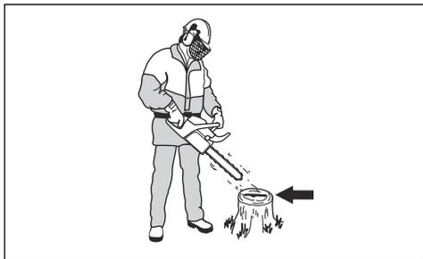
3. Se la lubrificazione della catena non funziona correttamente, eseguire un controllo della barra di guida. Per le istruzioni, fare riferimento a *Controllo della barra guida alla pagina 33*. Rivolgetevi al vostro rivenditore se le operazioni di manutenzione non risolvono il problema.
