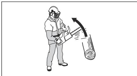
Un piccolo raggio sulla punta della barra diminuisce la forza del contraccolpo.
