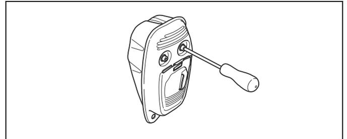
4. Wenn der Schalldämpfer an Ihrem Gerät ein Funkenfängernetz hat, führen Sie eine Sichtkontrolle durch.
