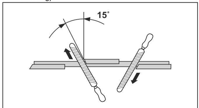
**Hinweis:** Schärfen Sie die Kanten der Zähne mit einer Flachfeile, falls die Klinge stark abgenutzt ist. Schärfen Sie danach mit einer Rundfeile weiter.
