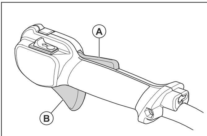
2. Drücken Sie die Gashebelsperre herunter, und kontrollieren Sie, ob sie beim Loslassen in die Ausgangsstellung zurückkehrt.
