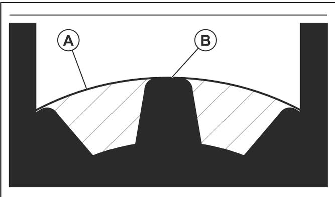
5. Wenn der Schmierfettstand zu niedrig ist, füllen Sie das Winkelgetriebe mit Husqvarna Schmierfett für Winkelgetriebe. Füllen Sie es langsam ein, und drehen Sie die Antriebswelle dabei. Stoppen Sie beim korrekten Füllstand (B).
