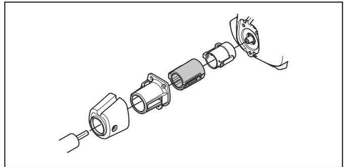
3. Stellen Sie sicher, dass die Antivibrationseinheiten korrekt angebracht sind.
