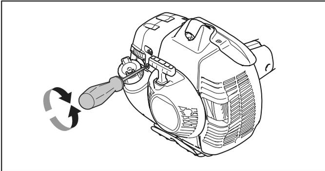
2. Drehen Sie die Einstellschraube gegen den Uhrzeigersinn, bis die Schneidausrüstung stehen bleibt.
