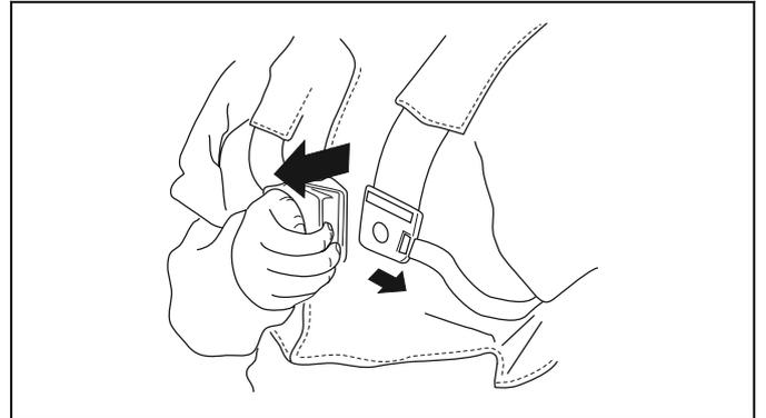
In einem Notfall hilft Ihnen die Schnelllösefunktion, das Gerät sicher zu entfernen.
