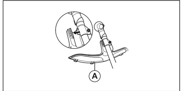
2. Stellen Sie sicher, dass die Schutzverlängerung entfernt wurde.
