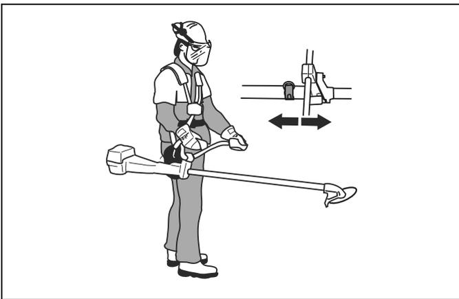
Beim Grasfreischneiden ist das Gerät korrekt ausbalanciert, wenn sich die Klinge auf Schnitthöhe in Bodennähe befindet.
