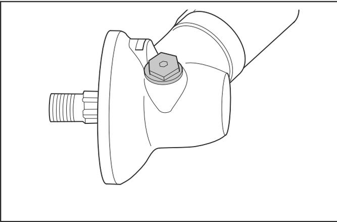
4. Sehen Sie in die Schmiernippel-Öffnung hinein, und drehen Sie die Antriebswelle. Der Schmierfettstand (A) muss sich auf Höhe der Zahnoberseite (B) befinden.
