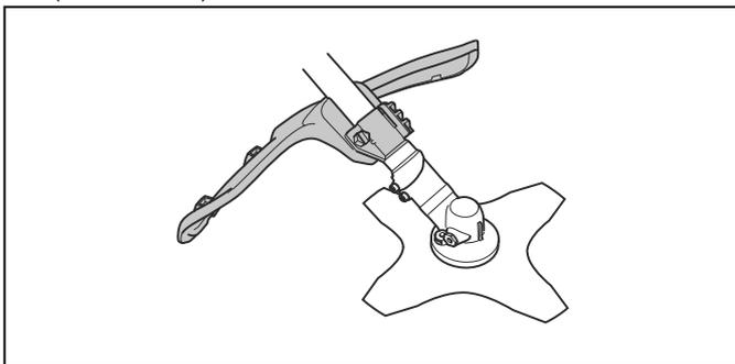
2. Den Schutz für die Schneidausrüstung bei Beschädigung ersetzen.
