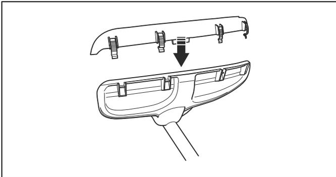
2. Bringen Sie die Schutzabdeckung an der Schutzvorrichtung der Schneidausrüstung mit den 4 Verschlusslaken in Position.
