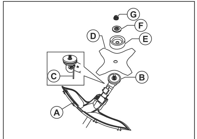
6. Stellen Sie sicher, dass das Mitnehmerrad und der Stützflansch korrekt im Mittelloch der Grasklinge einrasten.
