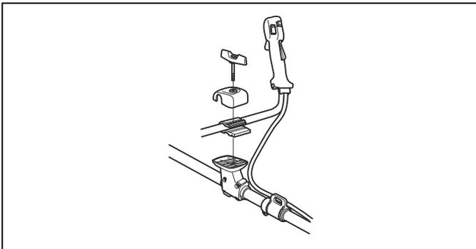
2. Stellen Sie sicher, dass die Öffnungen für den Drehknopf korrekt ausgerichtet sind.
