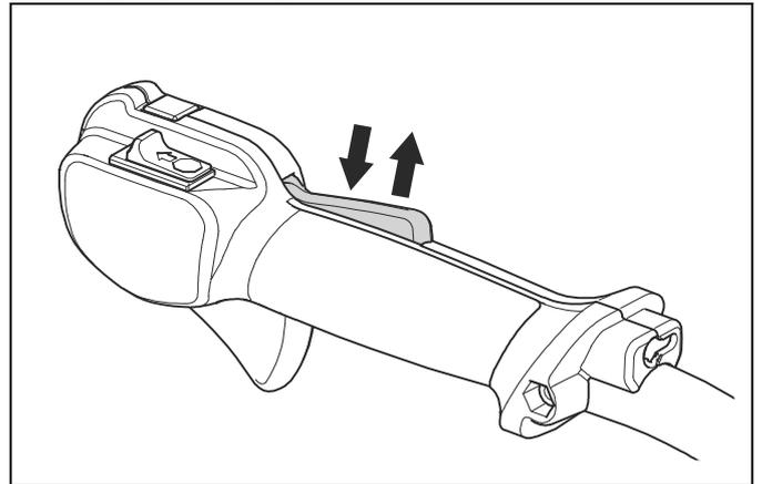
3. Stellen Sie sicher, dass der Gashebel in der Leerlaufstellung verriegelt ist, wenn die Gashebelsperre freigegeben wird.
