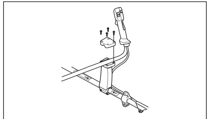
2. Stellen Sie sicher, dass die Öffnungen für die Schrauben korrekt ausgerichtet sind.
