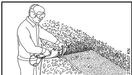
Bei breiten Hecken in mehreren Arbeitsgängen vorgehen – eine Hand am Schaltbügel – eine Hand am Bedienungsgriff.
