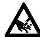
Bei laufendem Motor Schneidmesser nicht berühren. Werden die Schneidmesser durch einen Gegenstand blockiert, sofort Motor abstellen und Netzstecker ziehen – dann erst den Gegenstand beseitigen – **Verletzungsgefahr!**
