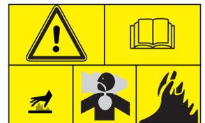
Vergiftungsgefahr. Das Abgassystem des Gerätes setzt giftige Gase frei. Den Motor niemals in geschlossenen Räumen starten.
