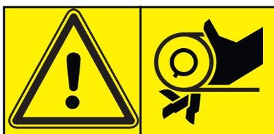
Achtung Keilriemenantrieb! Quetschgefahr
