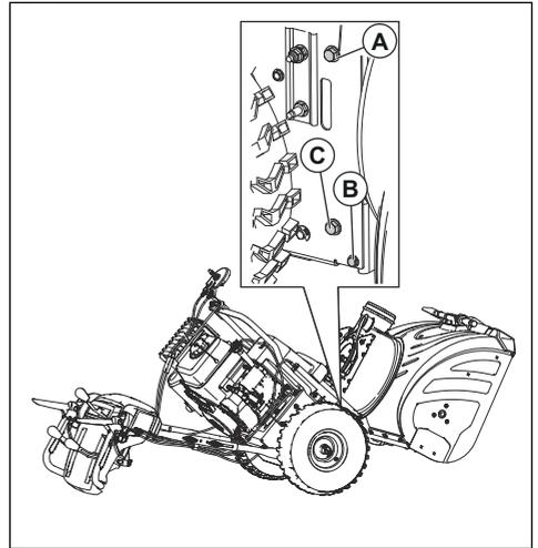
2. Desserrez, sans les retirer, les boulons inférieurs de 5/16" (C) des deux côtés du châssis.
