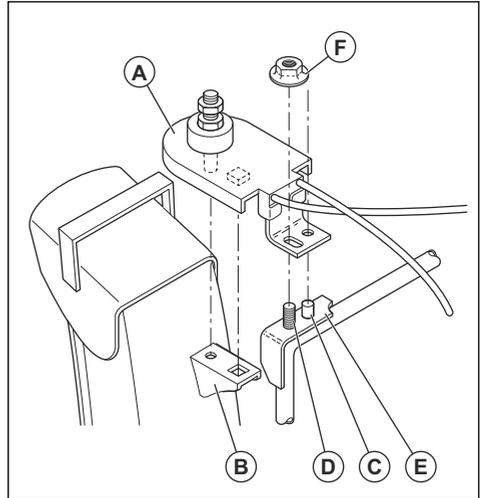
3. Placez la tête de rotation de la goulotte sur la broche (C) et sur le goujon fileté (D) sur le support de montage (E).
