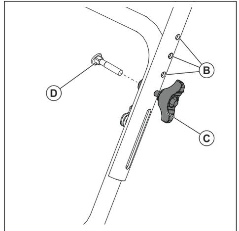
3. Installez plus de boulons de carrosserie (D) et de boutons de poignée (C) pour fixer la poignée supérieure (A) sur la poignée inférieure (E).
