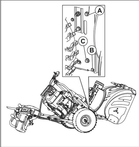
6. Installez les boulons 1/4" (B) et serrez-les (4-6 ft lbs / 5-8 Nm).
