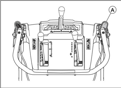
2. Soulevez le levier de régulation du régime d'entraînement (B) depuis la position centrale pour que le produit se déplace vers l'avant lorsque l'engagement de l'entraînement (C) est engagé. Ne modifiez pas la vitesse lorsque le levier d'entraînement est enclenché. Cela peut endommager la transmission.
