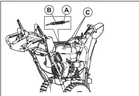
2. Maintenez la section courte et tournez la section longue pour augmenter le dispositif de réglage.
