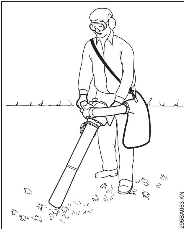
Der Saughäcksler ist für Zweihand-Bedienung ausgelegt. Er muss von der Bedienungsperson mit der rechten Hand am Bedienungsgriff und mit der linken Hand am Griff des Gehäuses getragen werden.
