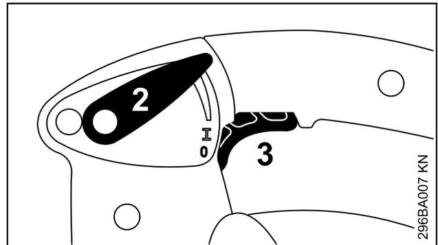
Mit dem Stellhebel (2) kann der Gashebel (3) während der Arbeit in beliebiger Stellung arretiert werden.
