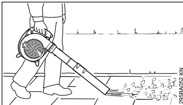
Das Blasgerät ist für Einhand-Bedienung ausgelegt. Es muss von der Bedienungsperson mit der rechten Hand am Bedingungsgriff getragen werden.
