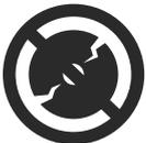
Stellen Sie sicher, dass die Trennscheibe keine Risse oder andere Beschädigungen aufweist.
