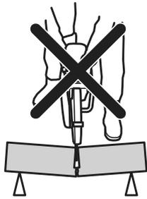
Wird die Klinge eingeklemmt oder bleibt sie im Rückschlagbereich stecken, kann die Heftigkeit der Rückschlageffekte zu heftigen Drehbewegungen und starkem Wackeln des Trennschleifers führen, was schwere oder tödliche Verletzungen verursachen kann. Auf mögliche Bewegungen des Werkstücks achten. Wenn das Werkstück nicht ausreichend gestützt ist und sich beim Schneiden verschiebt, kann es durch Einklemmen der Trennscheibe zu einem Rückschlag kommen.
