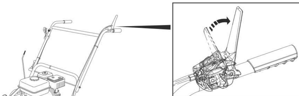
**D** REGLAGE GUIDON - REGLAJE DEL MANILLAR - ADJUSTING THE HANDLEBARS - EINSTELLEN - REGULACAO DO GUIADOR - REGOLAZIONE DEL MANUBRIO - REGULACJA KIEROWNICY - GIDONUN AYARLANMASI - ΡΥΘΜΙΣΗ ΤΙΜΟΝΙΟΥ - ΡΑΓCΙΠΡΟΒΙΑ ΒΑΕΕΑΒΉJЦЮΕΑ ΕΙΑΕJΙΑΑ
