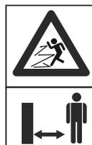
L'opérateur doit s'assurer qu'aucune personne ni aucun animal ne se trouve à moins de 15 m de la machine. Lorsque plusieurs opérateurs travaillent sur le même site, une distance de sécurité d'au moins 15 m doit être respectée. L'accessoire peut projeter violemment des objets pouvant ricocher. Ceci peut provoquer de graves blessures aux yeux si l'équipement de protection personnelle recommandé n'est pas utilisé.
