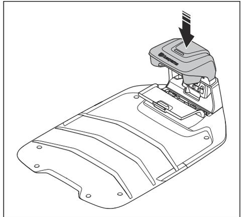
5. Sollevare e inclinare la parte superiore della stazione di ricarica.
