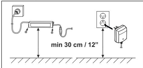
11. Collegare il cavo di alimentazione a una presa da 100-240 V.
