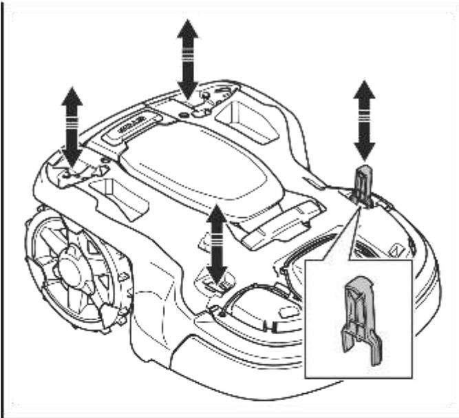
5. Drücken Sie das Wartungswerkzeug in einer der 4 Positionen nach unten, und ziehen Sie das Gehäuse nach oben.
