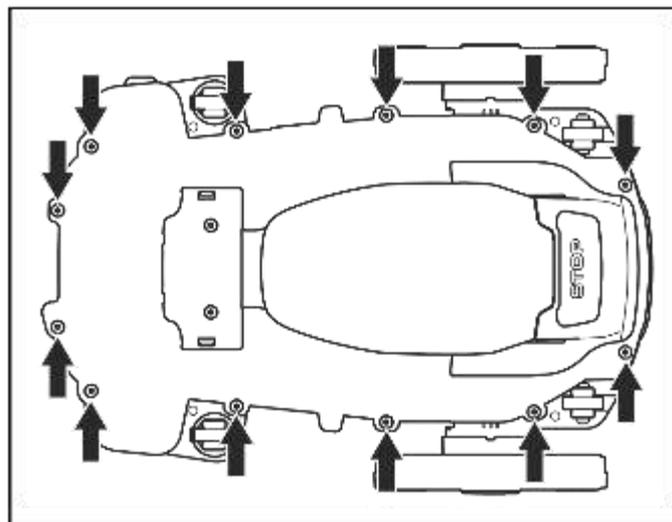
3. Heben Sie das Oberteil des Chassis an der Hinterkante an.
