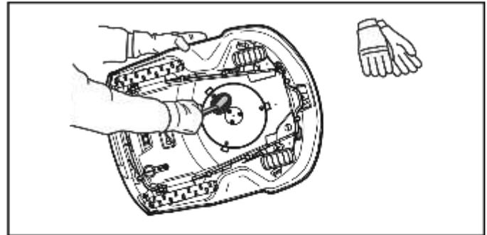
9. Um das Gehäuse des Geräts zu installieren, legen Sie es auf das Chassis und drücken es hinein.
