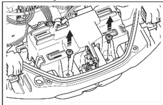
7. Drücken Sie auf die Klemmen, um sie zu lösen, und heben Sie den Akkuhalter an.
