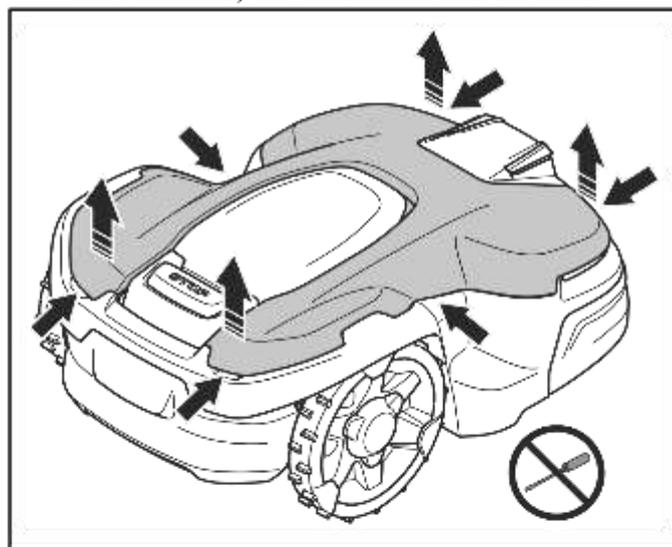
3. Heben Sie die obere Abdeckung an, um sie zu entfernen.
