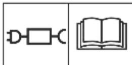
Verwenden Sie ein abnehmbares Netzteil wie auf dem Gerätetypenschild neben dem Symbol angegeben.
