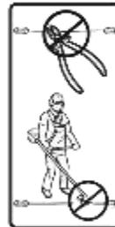
Das Niederspannungskabel darf weder gekürzt, verlängert noch gespleißt werden.
