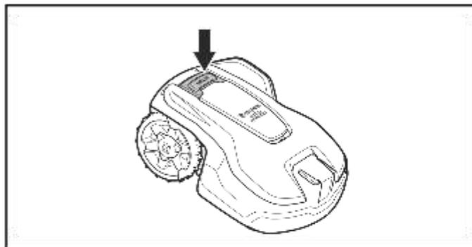
2. Drücken Sie 3 Sekunden lang auf die **ON/OFF**-Taste, und stellen Sie sicher, dass das Gerät ausgeschaltet ist. Vergewissern Sie sich, dass die Anzeigelampe auf dem Tastenfeld nicht leuchtet. Das bedeutet, dass das Gerät deaktiviert ist. Siehe *So bedienen Sie die ON/OFF-Taste auf Seite 33*.
