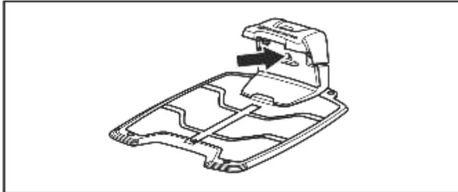
2. Prüfen Sie, ob Begrenzungskabelanschlüsse an der Ladestation korrekt vorgenommen wurden und nicht beschädigt sind. Prüfen Sie, ob die Anzeigelampe an der Ladestation noch immer blau blinkt.
