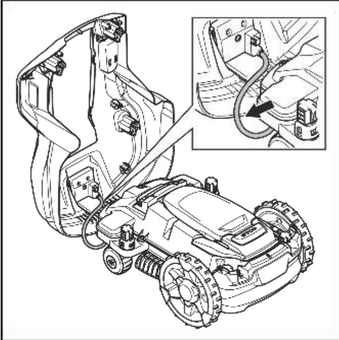
**Hinweis:** Stellen Sie sicher, dass die Durchführungen des Ladekabels nach dem Abnehmen des Gerätegehäuses korrekt installiert sind, um vor Feuchtigkeit zu schützen.
