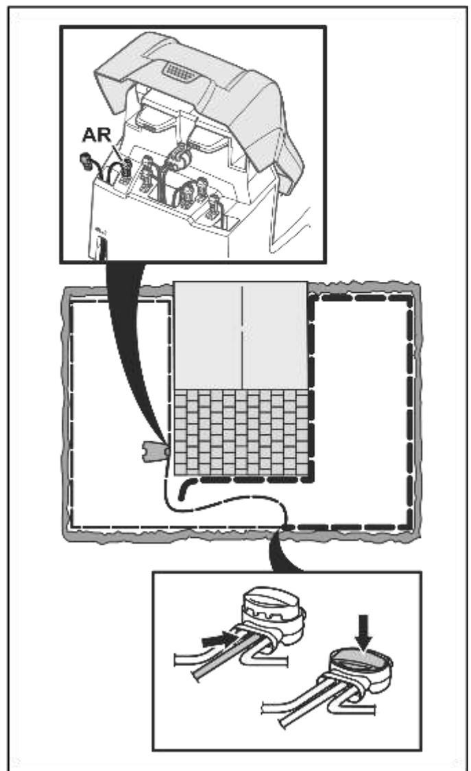
Leuchtet die Anzeigelampe jetzt grün, befindet sich der Bruch an einer Stelle zwischen dem ausgesteckten Ende und der Stelle, an der das neue Kabel angeschlossen wurde (dicke schwarze Linie unten). Verschieben Sie in diesem Fall das neue Kabel näher in Richtung ausgestecktes Ende
