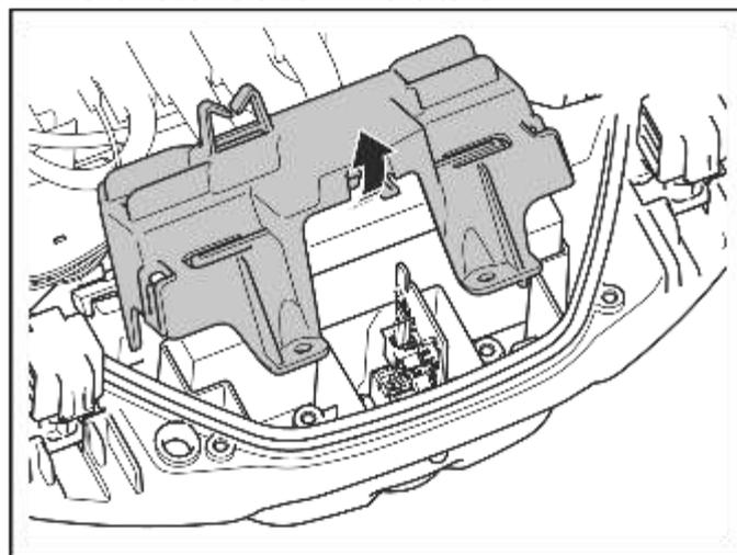
8. Trennen Sie das Akkukabel von der Hauptleiterplatte.
