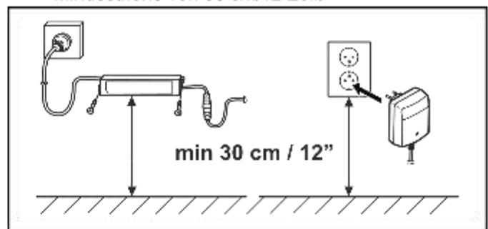
5. Schließen Sie das Netzteil an eine Steckdose mit 100–240 V an.
