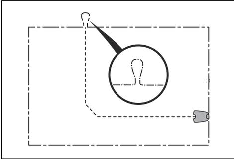
**Nota:** Fare uno schema dell'area di lavoro prima di installare il cavo perimetrale e il cavo guida.
