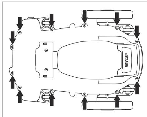
3. Sollevare il bordo posteriore della sezione superiore del telaio.
