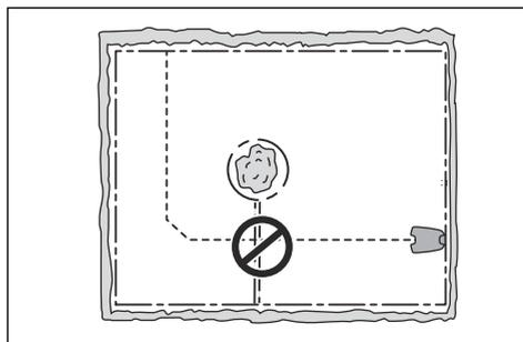
Per creare un'isola, isolare le parti dell'area di lavoro con il cavo perimetrale. Si consiglia di isolare tutti gli oggetti stabili nell'area di lavoro.
