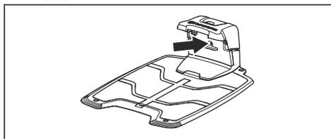
2. Se l'indicatore LED della lampada non è verde, eseguire un controllo della procedura di installazione. Fare riferimento a *Spia della stazione di ricarica alla pagina 44* e *Installazione della stazione di ricarica alla pagina 18*.
