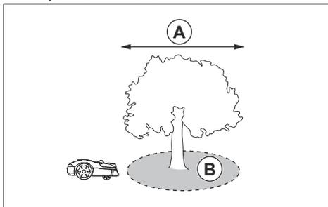
**Nota:** Alberi o gruppi di alberi con chioma di diametro (A) superiore a 4 m/13 ft possono causare arresti temporanei del prodotto. Alberi più piccoli non causano generalmente interferenze con il funzionamento del prodotto.
