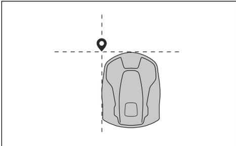
**Nota:** La posizione del punto di passaggio durante l'installazione di un percorso di trasferimento o di un percorso verso un punto di manutenzione si trova al centro del prodotto tra le ruote motrici.
