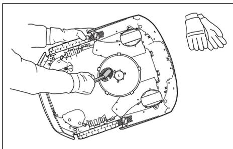
6. Pulire i soffietti del disco lama e il telaio con una spazzola. Allo stesso tempo, accertarsi che il disco lame ruoti liberamente. Assicurarsi che le lame non siano danneggiate e possano ruotare liberamente.
