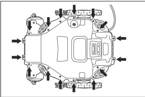
4. Sollevare la parte superiore del telaio.
