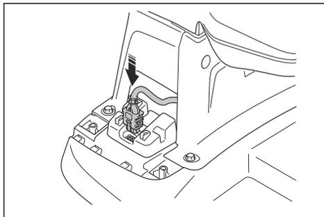
5. Installare la copertura del cavo con 2 viti.
