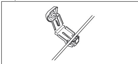
4. Chiudere il connettore usando un paio di pinze.
