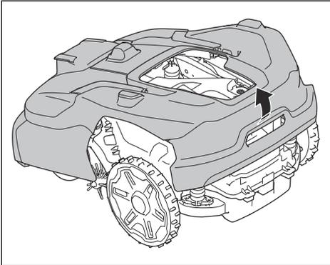
3. Rimuovere le 16 viti sul telaio con un cacciavite Torx 20.
