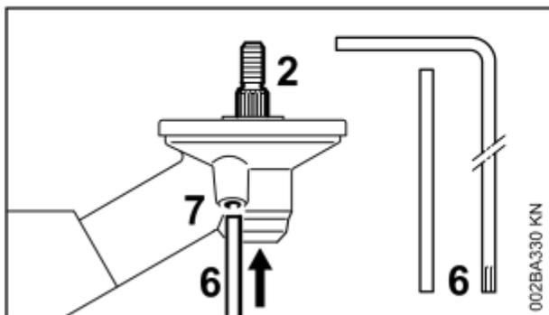
Pour le montage et le démontage des outils de coupe, il faut bloquer l'arbre (2) à l'aide du mandrin de calage (6) ou du tournevis coudé (6). Les pièces font respectivement partie du jeu de pièces joint à la livraison de la machine ou sont livrables à titre d'accessoire optionnel.
