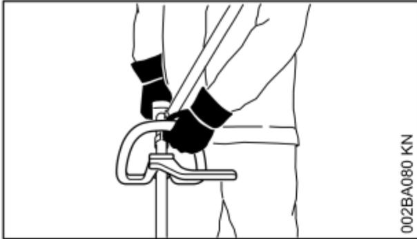
Sur les versions à poignée circulaire ou à poignée circulaire avec protection (pour garder une distance de sécurité entre l'outil et les pieds et jambes de l'utilisateur), tenir la poignée circulaire de la main gauche et la poignée de commande de la main droite – ceci est également valable pour les gauchers.
