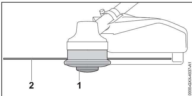
Si los hilos de corte tienen menos de 25 mm, no se pueden reajustar automáticamente.
