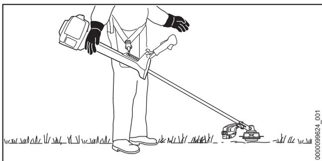
La herramienta de corte tiene que descansar ligeramente sobre el suelo.
