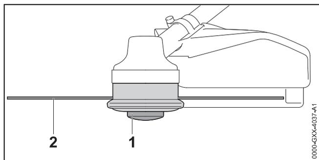
Si la longueur des fils de coupe qui dépasse est inférieure à 25 mm, une sortie automatique des fils de coupe n'est pas possible.
