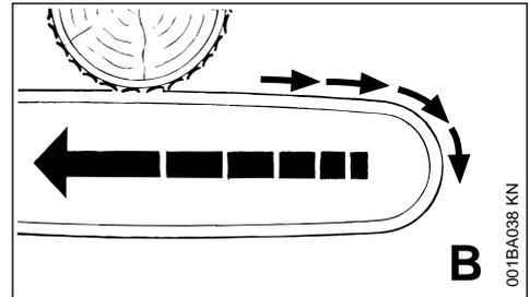
Cuando, al cortar con el lado superior de la espada – corte del revés – la cadena se aprisiona o topa en un objeto sólido en la madera, la motosierra puede retroceder de golpe hacia el operario – **para evitarlo:**
