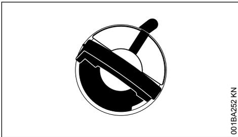
Las marcas en el cierre del depósito y en depósito de aceite tienen que estar alineadas entre sí
