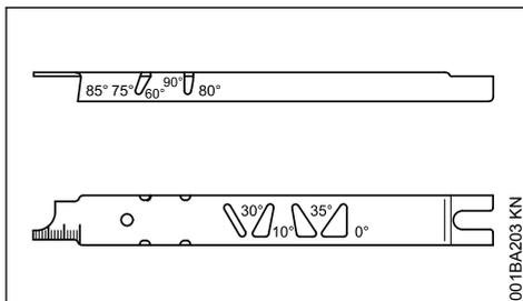
Plantilla de limado STIHL (accesorio especial, véase la tabla "Herramientas de afilar") – una herramienta universal para el control del ángulo de afilado y el de la cara de ataque, de la distancia del limitador de profundidad, la longitud de diente, la profundidad de la ranura y para limpiar la ranura y los orificios de entrada de aceite.
