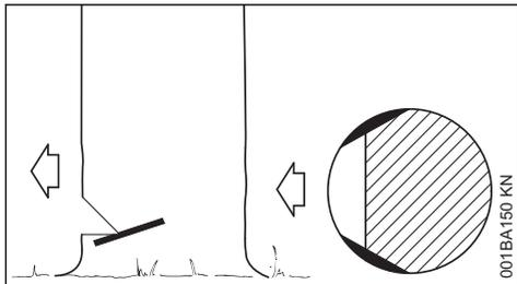
Los cortes de albura impiden que se desgarre la albura al talar el tronco en maderas de fibras largas – cortar en ambos lados del tronco a la altura de la base de la muesca de caída hasta aprox.  $1/10$  parte del diámetro del tronco – si se trata de troncos de cierto grosor, cortar hasta el ancho de la espada, como máximo.
