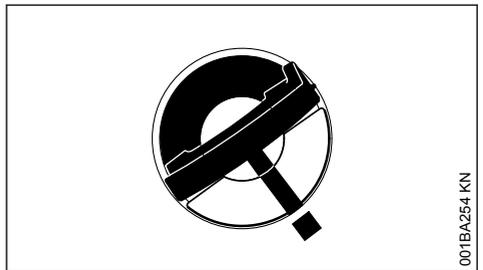
Entonces quedan alineadas entre sí las marcas en el cierre del depósito y en el depósito de aceite
