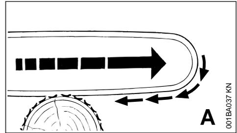
Cuando, al cortar con el lado inferior de la espada – corte normal – la cadena se traba o roza un objeto sólido en la madera, la motosierra puede ser absorbida repentinamente hacia el tronco – **para evitarlo, aplicar siempre de forma segura el tope de garras.**
