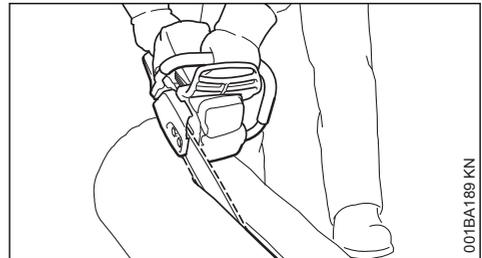
Técnica de aserrado sin utilizar el tope de garras – peligro de tirón hacia delante – aplicar la
