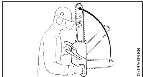
Al producirse un rebote (kickback), la sierra es lanzada repentinamente y de forma incontrolable hacia el operario.
