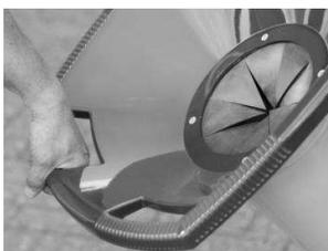
Für ein leichtes Transportieren der Maschine sind Haltegriffe am Fülltrichter vorhanden.
