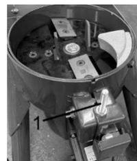
Zum Schließen, den Fülltrichter zuklappen. Dabei darauf achten, dass die Schraube (1) durch die Bohrung ragt (Bild rechts). Die Kunststoffscheibe wieder auflegen und den Fülltrichter mit der Sterngriffmutter fest verschließen.
