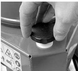
Der Fülltrichter lässt sich leicht öffnen. Den laufenden Motor am STOPP-Schalter ausschalten und anschließend den Netzstecker abziehen. Wenn die Messerscheibe stillsteht, die Sterngriffmutter abdrehen und die Kunststoffscheibe entfernen. Der Fülltrichter lässt sich nun aufklappen.
