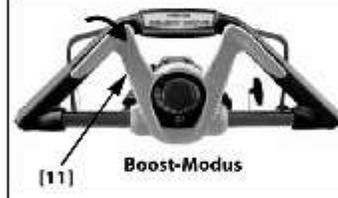
5. Wenn Sie die gewünschte Mähgeschwindigkeit bei Herunterdrücken der Select Drive-Steuerung [11] in Kombination mit der entsprechenden Einstellung des Select Drive-Steuerungsknopfs [13] gefunden haben, können Sie mit konstanter Geschwindigkeit mähen.
