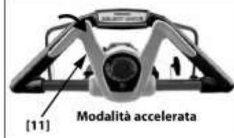
6. Spingere il comando Select Drive [11] con il pollice nell'apposita rientranza quando è necessario aumentare la potenza per mantenere la velocità di avanzamento desiderata (ad esempio su un pendio o in altre situazioni di terreno variabile). Non appena le condizioni del terreno rientrano nella normalità, è sufficiente rilasciare il comando di potenziamento.
