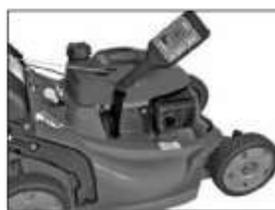
5. Dopo avere sostituito l'olio e prima di avviare il motore, verificare il livello dell'olio posizionando il rasaerba su una superficie piana.
